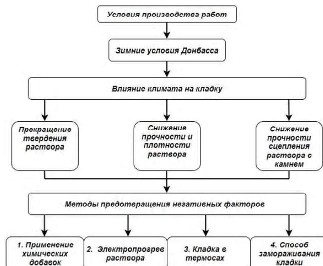
Рисунок 2 – Схема методов выполнения каменной кладки в зимний период.
