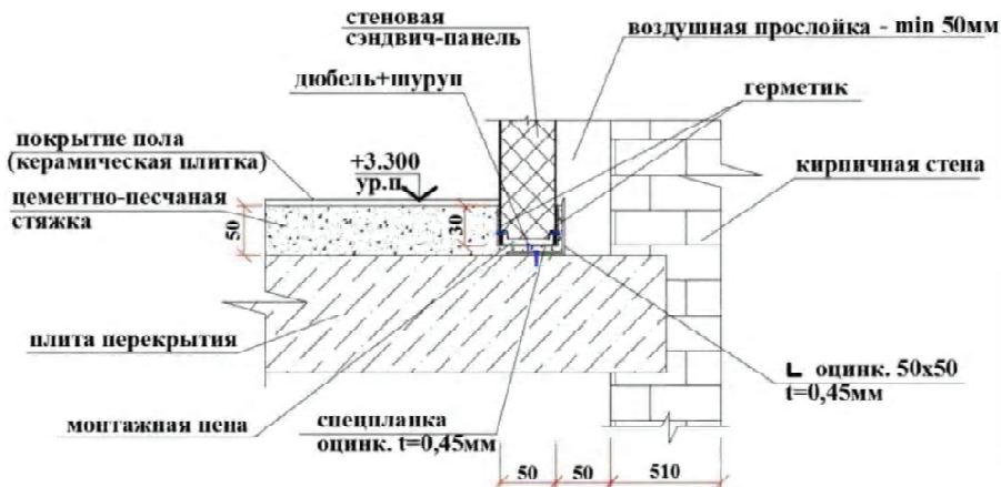
Рисунок 7 – Примыкание внутреннего теплового контура в конструкцию пола.
