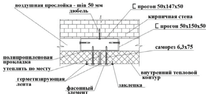
Рисунок 5 – Горизонтальное расположение сэндвич-панелей.
