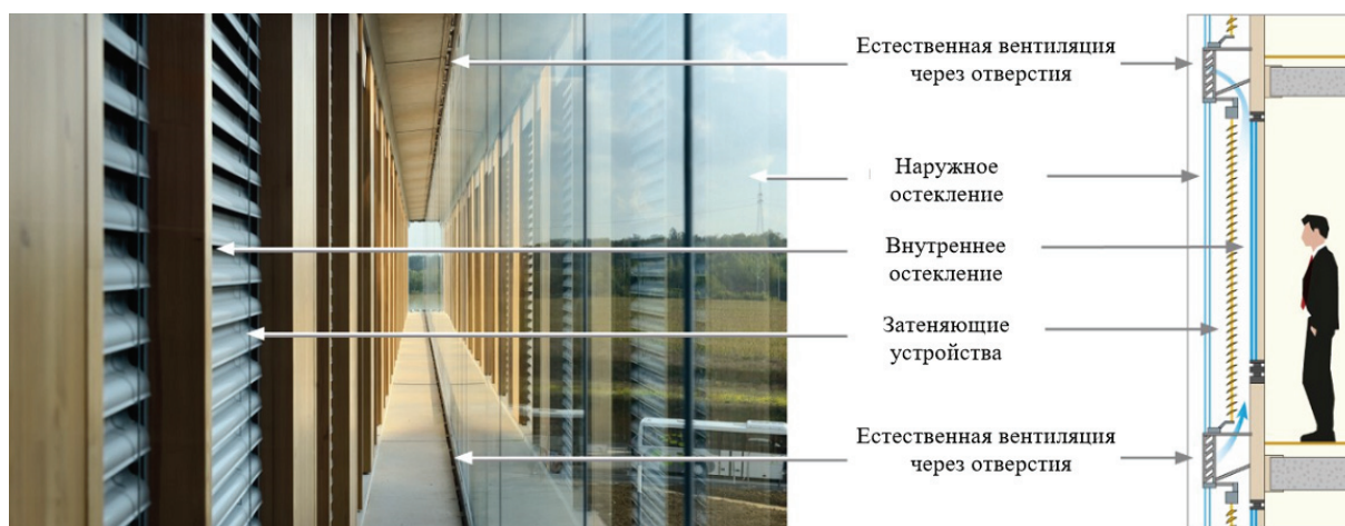
Рисунок 1 – Конструкция двойного фасада, DSF.
