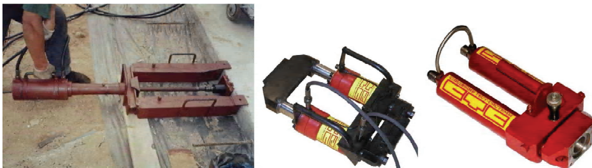
Рисунок 1 – Механическое натяжение арматуры с использованием гидродомкратов.
