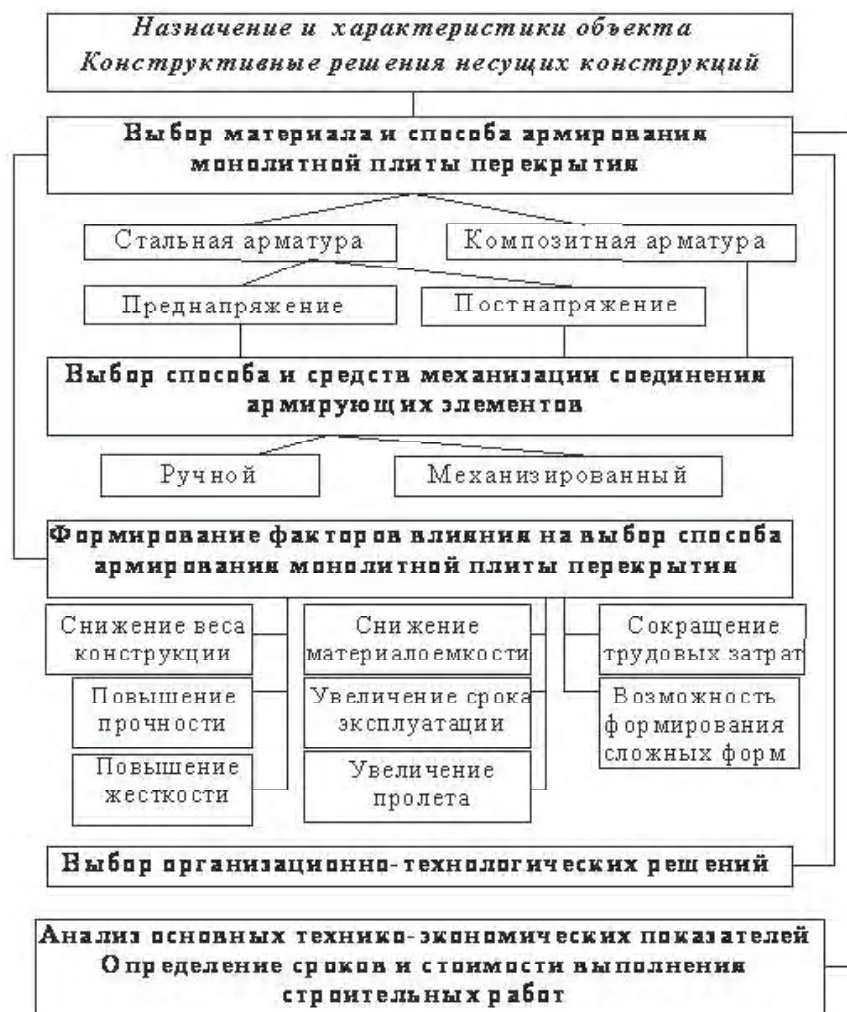
Рисунок 2 – Блок-схема повышения эффективности возведения монолитной плиты перекрытия.
