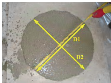
Рисунок 1 – Определение диаметра расплыва смеси (Flow spread S, мм).
