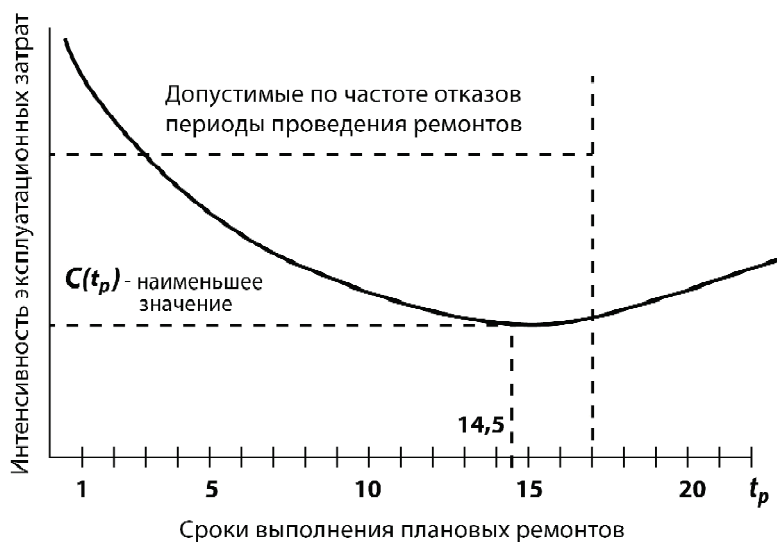
Рисунок 2 – Зависимость между выигрышем в надежности и материальными затратами на его достижение при предупредительной замене конструкций.
