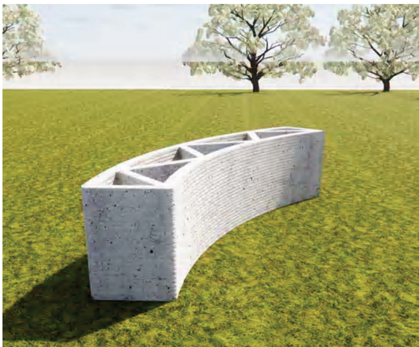
Рисунок 3 – Изображение типового блока длиной L = 2\,500 мм с типом внутренней топологии решетки № 1.
