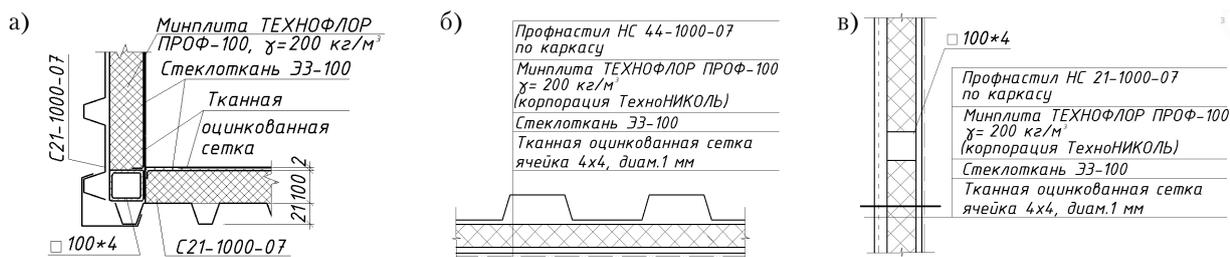
**Рисунок 2** – Конструкция акустических укрытий АУ1, АУ2, АУ3: а) крепление стенки к каркасу (узел 1); б) покрытие (узел 2); в) стенка (узел 3).
