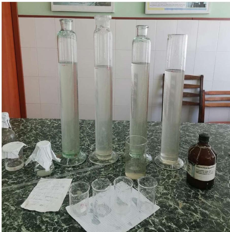
**Рисунок** – Лабораторные исследования эффективности третичного отстаивания.
