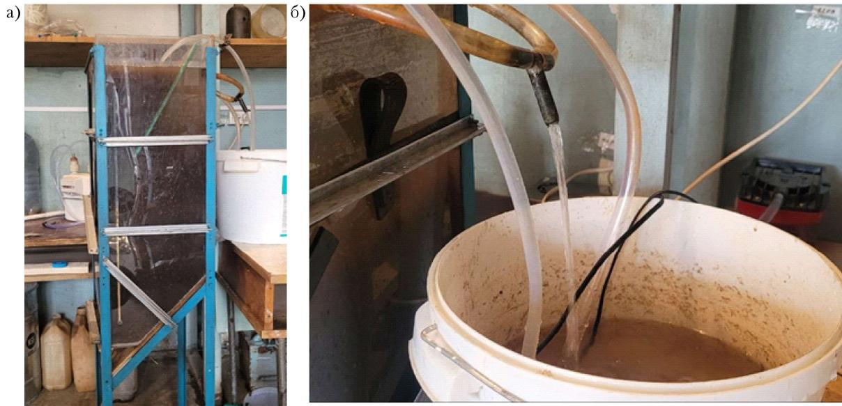
Рисунок 2 – Полупромышленная установка эрлифтного биореактора: а) общий вид; б) отвод осветленной воды.
