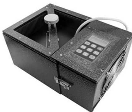
Рисунок 3 – Прибор для измерения теплопроводности материалов ИТС-1.
