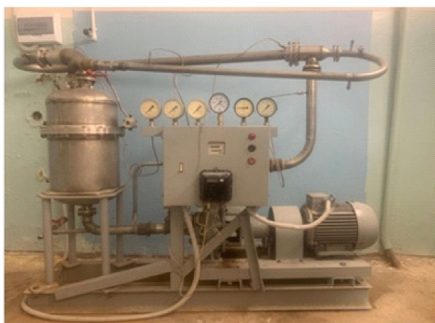
Рисунок 1 – Автономная теплогенерирующая установка и ее принципиальная схема: ЖГС – жидкостно-газовый смеситель; ТГЭ – теплогенерирующий элемент; НЦ – агрегат электронасосный; ШУ – шкаф управления; КР1-КР4 – кран шаровой; К31, К32 – задвижка; МН1-МН4, МН-6 – манометр; МН5 – мановакууметр; ТТ – термометр цифровой; РХМ – водосчетчик; Р – электрический счетчик.
