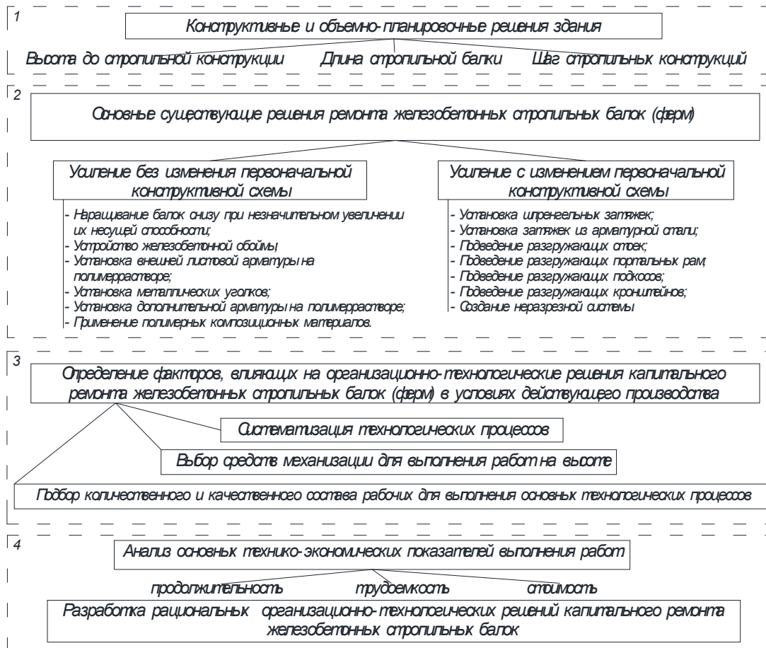
Рисунок 2 – Блок-схема выбора наиболее эффективного организационно-технологического решения выполнения работ при усилении железобетонных стропильных балок (ферм).
