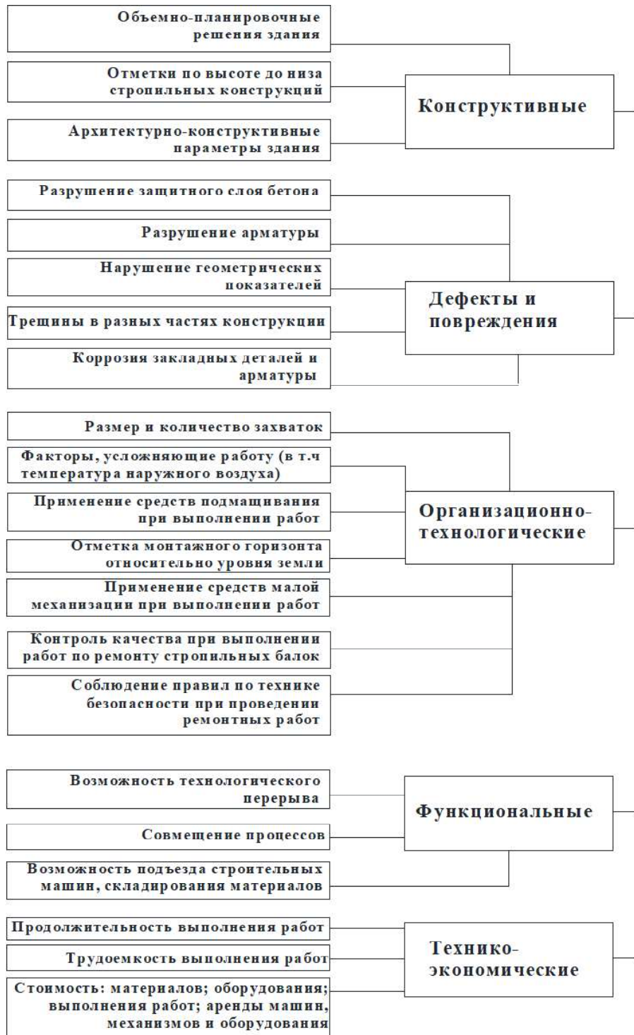
Рисунок 3 – Факторы, оказывающие влияние на параметры организационно-технологического процесса усиления железобетонных стропильных балок (ферм).
