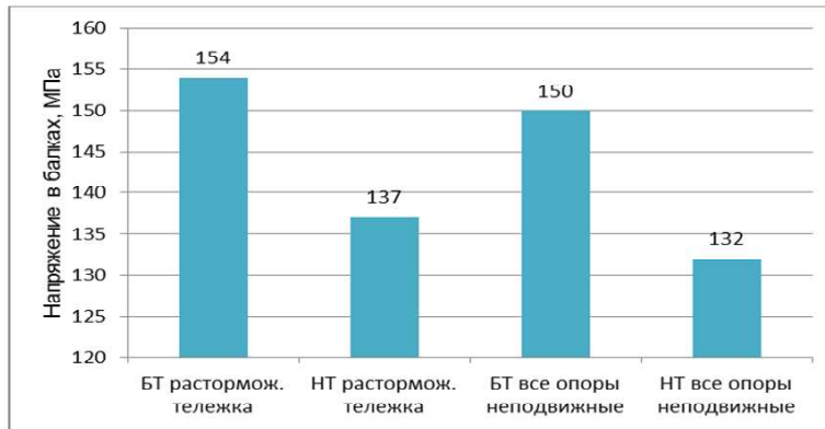
Рисунок 8 – Гистограмма максимальных напряжений в балках верхнего строения трехопорного портала (БТ – базовое исполнение, НТ – новое исполнение).
