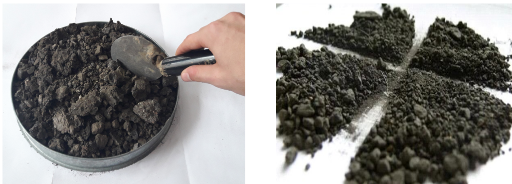
Рисунок 3 – Отбор проб асфальтогранулята методом квартования в лабораторных условиях.
