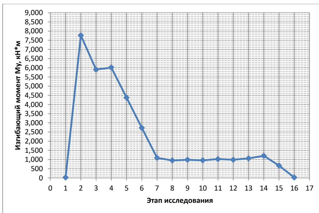
Рис. 4.10. Максимальный изгибающий момент M_y в элементах 1-10 при многоэтапном выравнивании по 3-6 см в ПК Лира.
