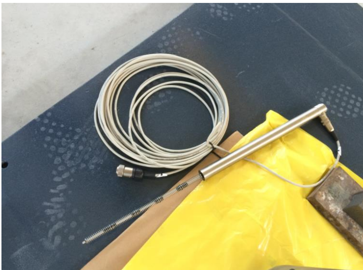
Рис. 2.7. Дополнительное устройство для измерения вертикального перемещения штампа.
