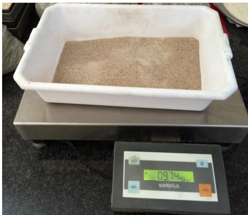
Рис. 2.8. Взвешивание песка для проведения экспериментального исследования устройства для регулирования вертикального положения здания в пространстве.
