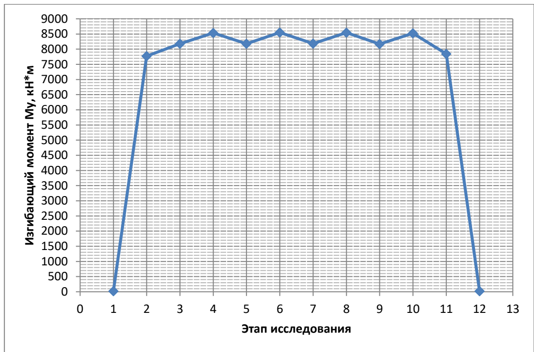
Рис. 4.17. Максимальное значение изгибающего момента M_y в элементах 1-10 при многоэтапном выравнивании по 30 см в ПК Лира.
