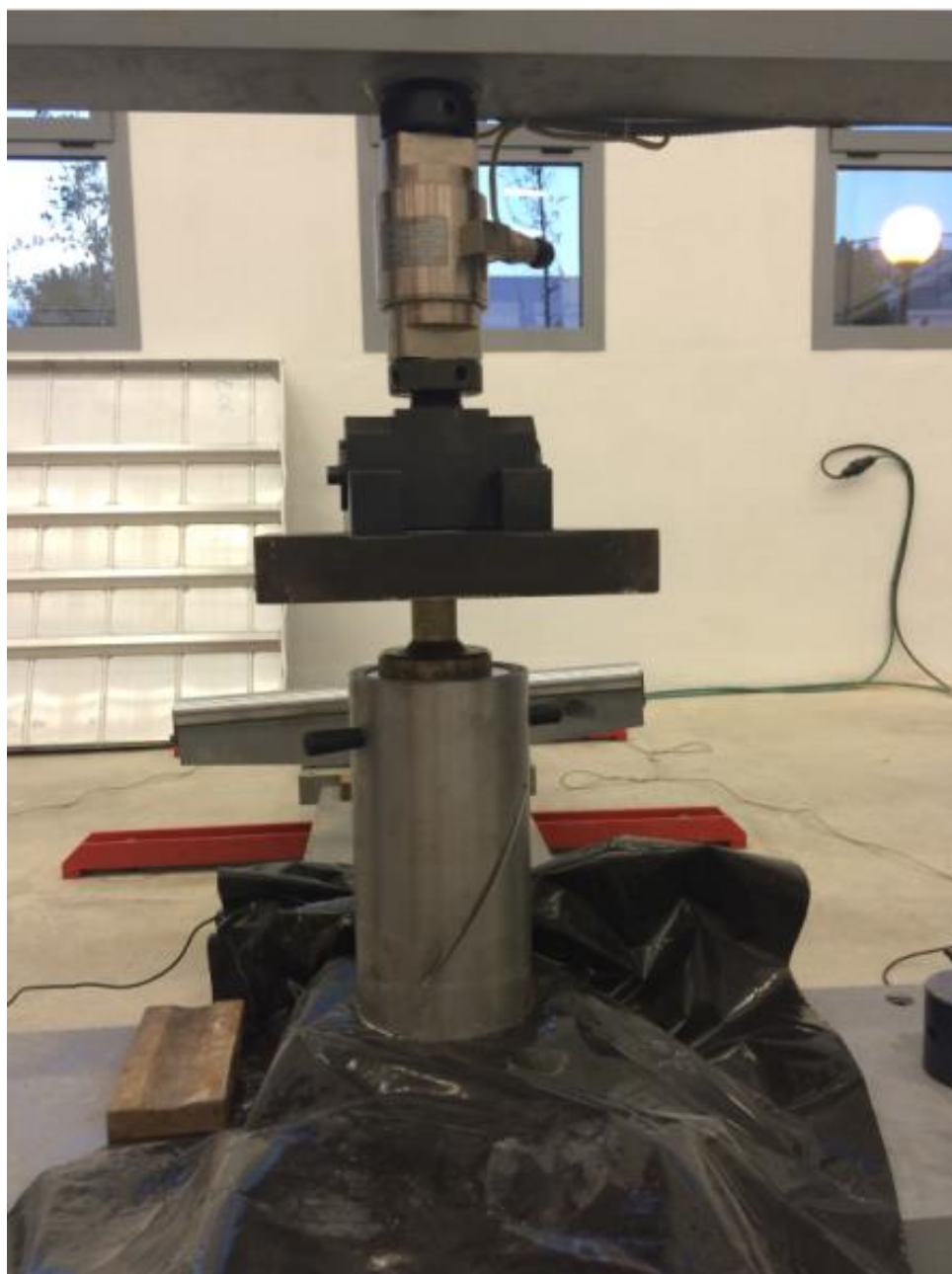
Рис. 3.3. Исследование влияния предварительного нагружения, влажности песка и времени нагружения на деформативность песка.
