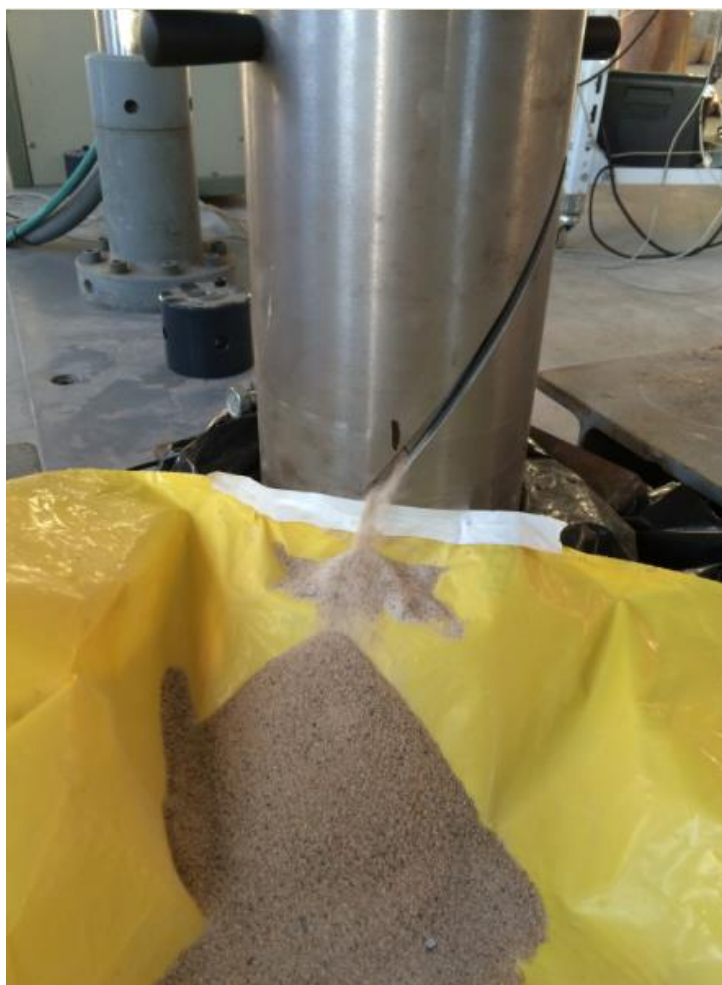
Рис. 3.16. Работа устройства для регулирования вертикального положения здания в пространстве при пересечении прорезей на отметке 27 см.
