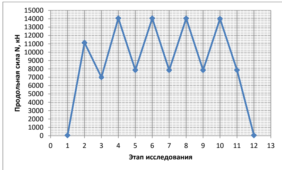
Рис. 4.19. Максимальная растягивающая продольная сила N в элементах 1-12 при многоэтапном выравнивании по 30 см в ПК Лиры.
