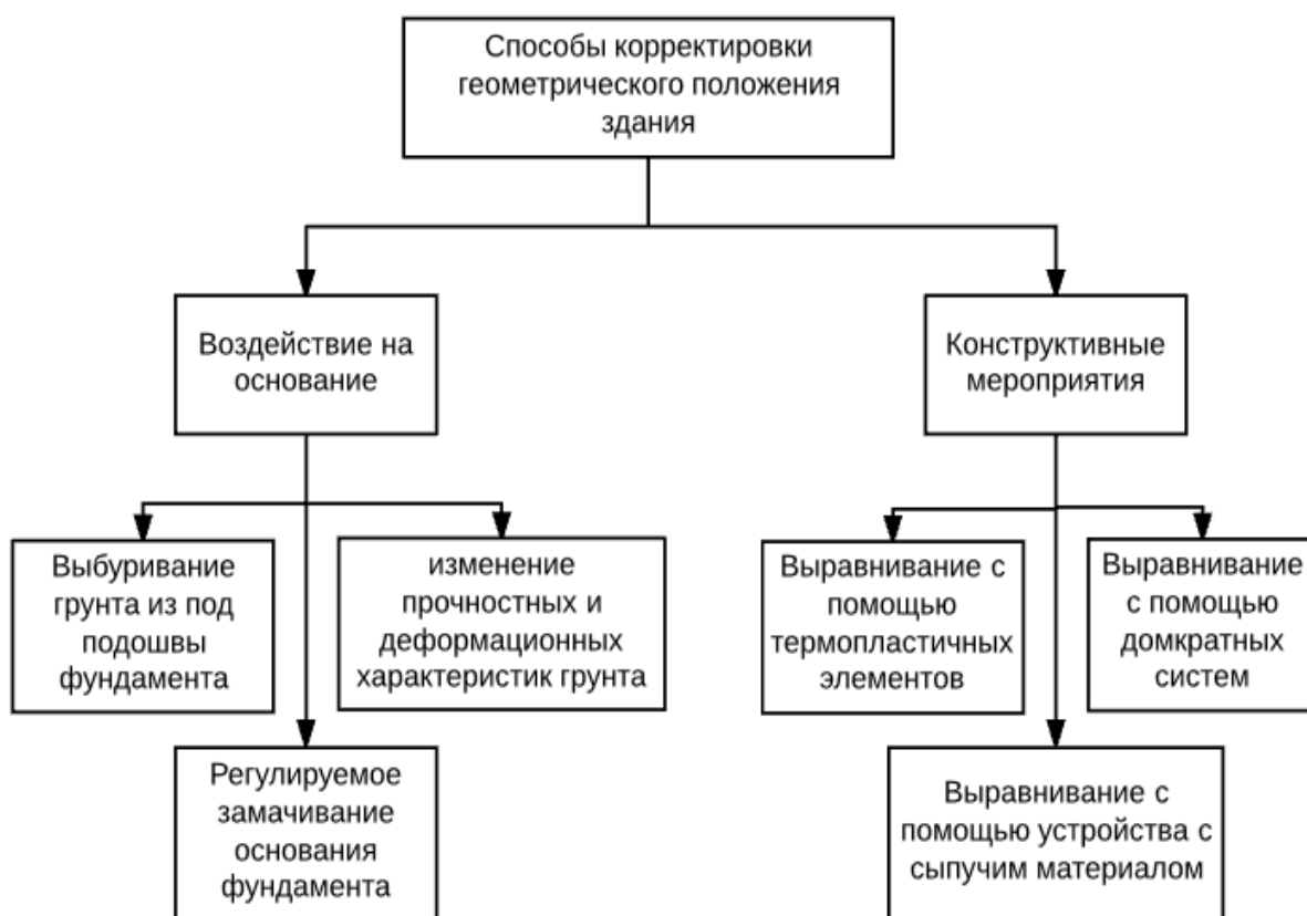
Рис. 1.13. Способы корректировки геометрического положения здания в пространстве.
