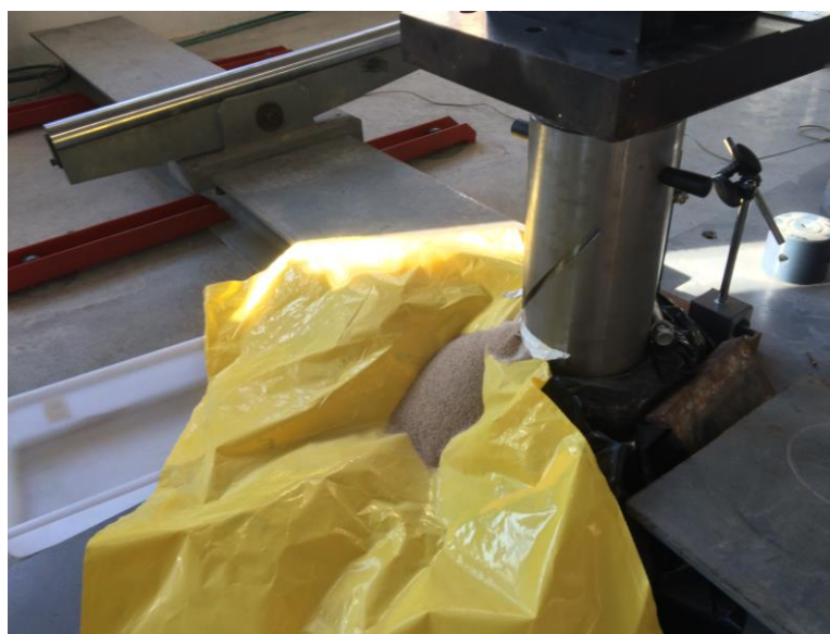
Рис. 3.11. Устройство для регулирования вертикального положения здания в пространстве после закрытия отверстия.
