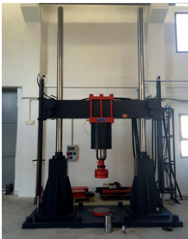
Рис. 2.6. Испытательный каркас марки ME406 испанской фирмы Servosis.
